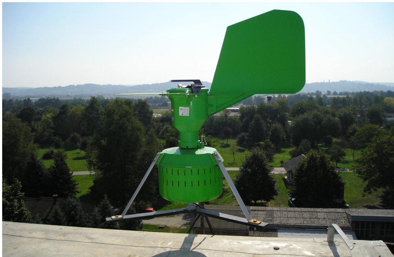
Slika 2: Hirstov uređaj za sakupljanje peludi na krovu Opće bolnice Virovitica
